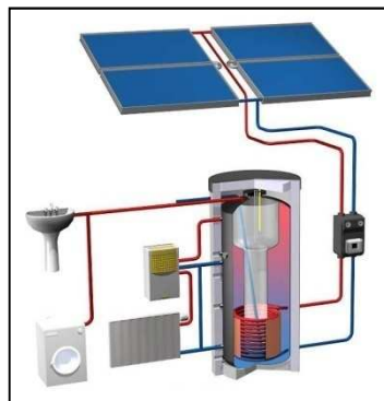
Eau chaude sanitaire solaire
