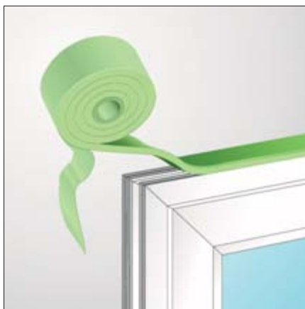
Fig. 3 : Pose en 1 seul passage
